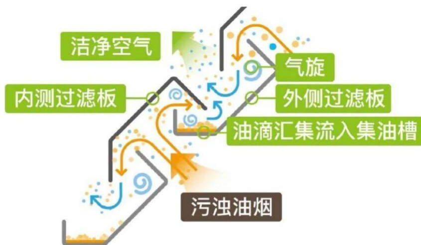
图 A.1 机械过滤器原理示意图
